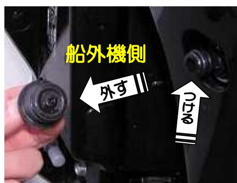
※船外機側は、ボトムカウル下のフラッシング接続部のキャップを外し、
