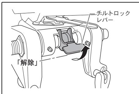
3. エンジンカバー後部のチルトアップハンドルに手をかけ、最大チルトアップ位置になるまで、手前（船首側）に引いてください。
