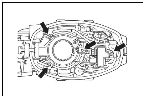
7. リコイルスターターを取り外し、燃料ホースがつながった状態で、燃料フィルター側へ回してください。ベーパーセパレーターに取り外したエバポレーションホースを再度接続してください。
