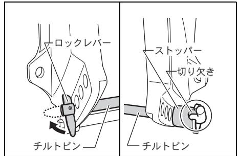
2. チルトピンを押し込み、ロックレバーを水平にします。
