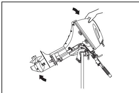
4. シャロードライブアームが自動的にクランプブラケットの溝に入りチルト位置が固定されます。
