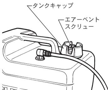
スズキ純正の燃料タンクは、以下の部品で構成されています。
